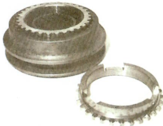
FIG. B - SYNCROMESH
